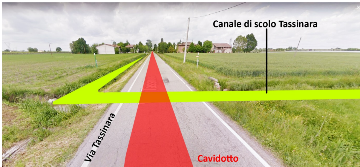
Figura 17. Interferenza E (insezione canale di scolo Tassinara), superamento tramite TOC (Tipico 6)
