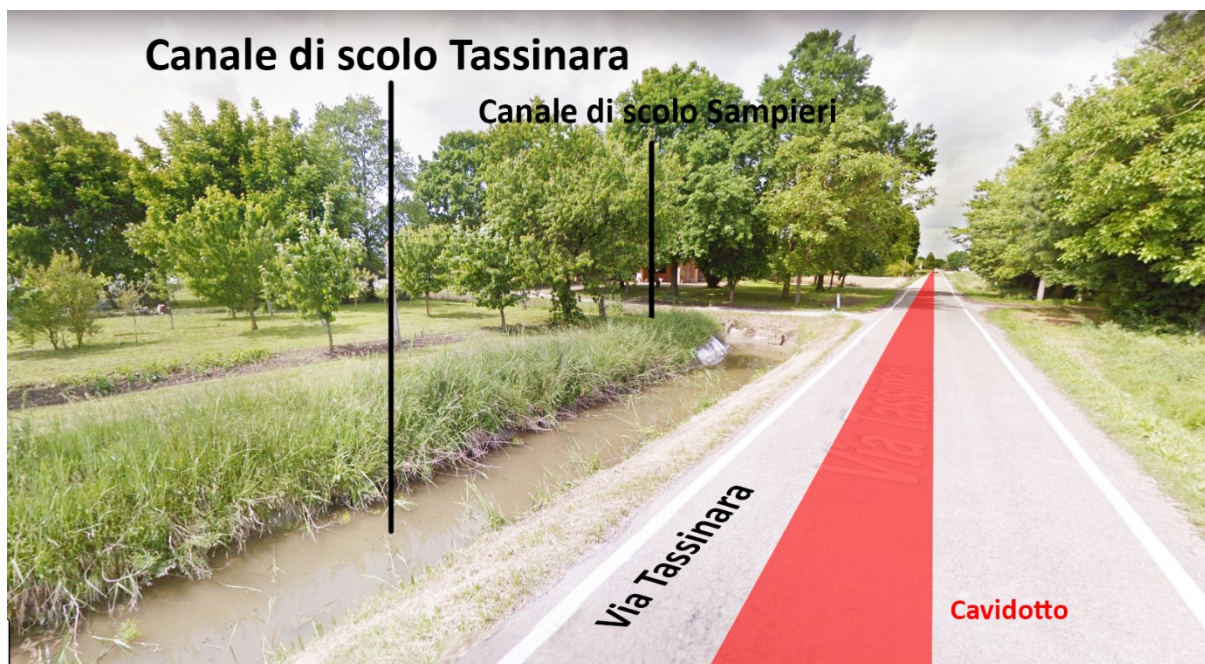
Figura 15. Interferenze C (prossimità a canale di scolo Sampieri) e D (parallelismo con canale di scolo Tassinara). Il cavidotto non interagisce direttamente con il canale, che rimane fuori dalla fascia di rispetto del cavidotto (figura 2).
