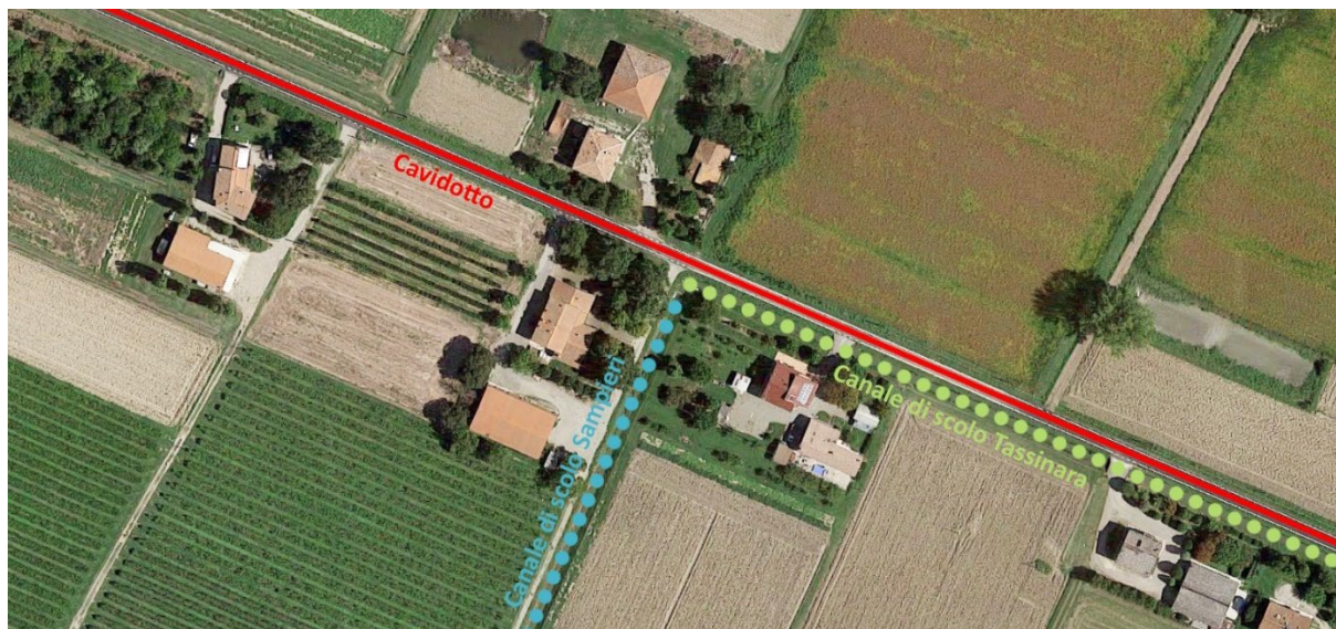
Figura 14. Zoom in corrispondenza delle interferenze C (proximità a canale di scolo Sampieri) e D (parallelismo con canale di scolo Tassinara). Il cavidotto non interagisce direttamente con il canale, che rimane fuori dalla fascia di rispetto del cavidotto (figura 2).
